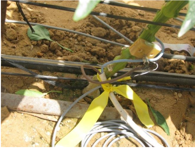
תמונה 5.6.1- חיישן ה- H.P. ומחטי החום המותקנים על שיה פלפל בבשור
