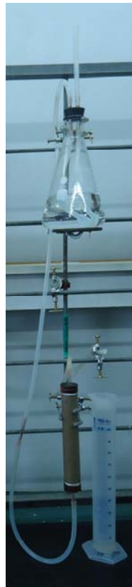
איור 3.3. מערכת בקבוק המריוט ששימשה לבדיקת המוליכות ההידראולית ברוויה בדוגמה בלתי מופרת, שנדגמה בדחיקה ישירה. המערכת שומרת על עומד מים עליון קבוע בתחתית הבקבוק ועומד מים תחתון קבוע בפתח צינורית הניקוז.
