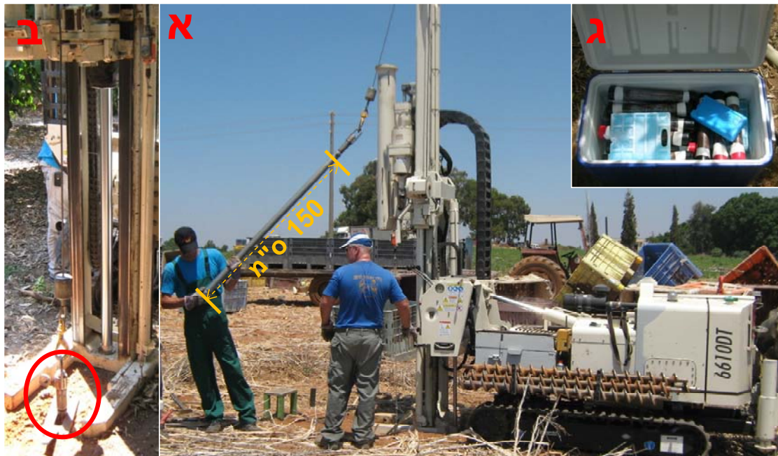
איור 3.2. (א) הוצאת שרול דיגום באורך 150 ס"מ, באמצעות מכונת הקידוח "Geoprobe 6610DT", בשטח לא מעובד בקריית שלמה. (ב) שרול הדיגום מוצא מתוך חור הקדח בפרדס בתל יצחק. (ג) שרולי דיגום חתוכים לדוגמאות, פקוקים ואטומים, מאוכסנים בצידנית מקוררת.
